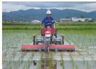
省力的な有機栽培を可能とする 高能率水田用除草機
